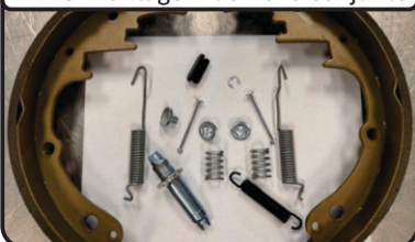
4. Pré-montagem do novo conjunto
